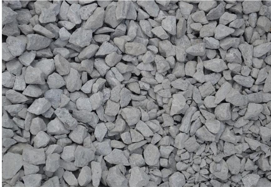
Figure 1: Aggregati riciclati al termine della lavorazione
