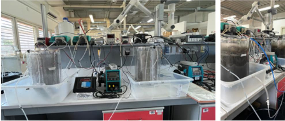
Figure 8: Tecnologie SFDMBR ed e-SFDMBR a scala di laboratorio, presso il Laboratori di Ingegneria Sanitaria Ambientale (SEED), UniSa (IT).
